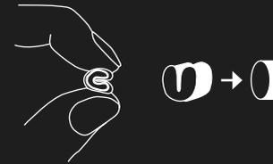
Pliez l'adaptateur en forme de coeur pour l'insérer dans la bague.
