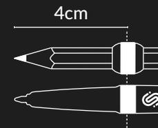
Ajustez la distance entre la pointe du crayon et la bague (environ 4 cm) en comparant avec le stylo iskn.
